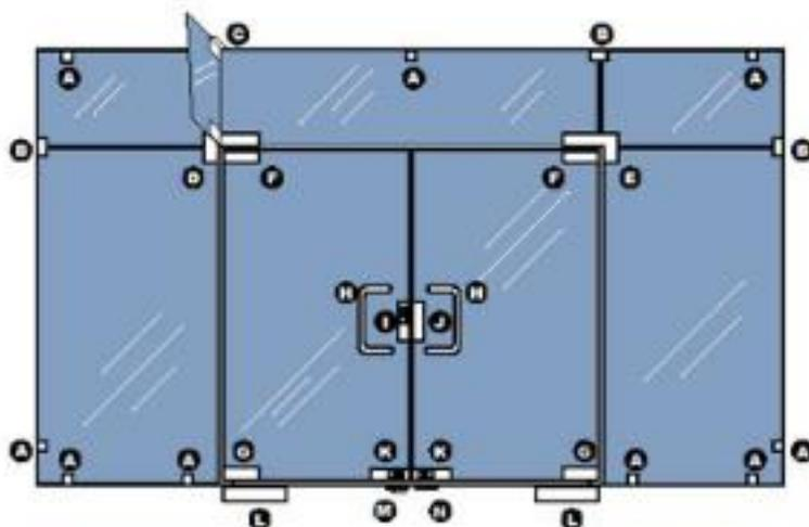
Puertas fabricadas en vidrio templado de 10mm y 12mm de espesor, con sus cantos pulidos rectilíneo. Estas puertas van fijadas con herrajes (pivote superior, pivote inferior, quicio, tirador recto tipo H y cerradura (central o esquinada).)
